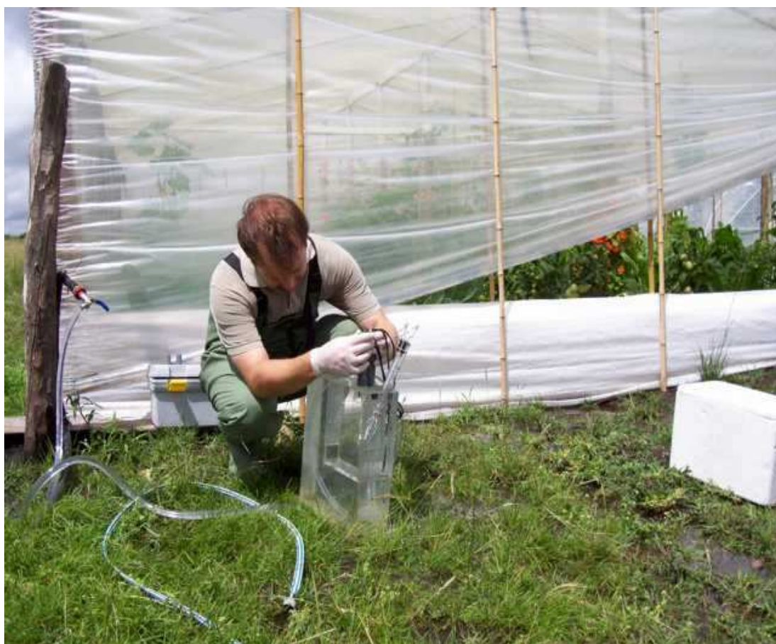
Muestreo con celda de flujo continuo – Rincón de Valentín (Salto-Uruguay)
